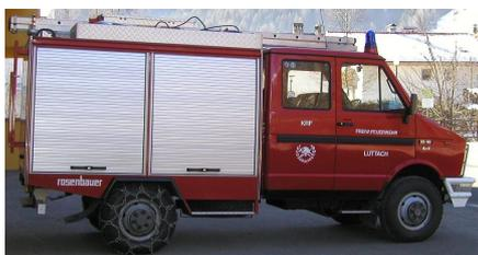
Da wie bei jeder Feuerwehr die Verkehrsunfälle und technischen Hilfeleistungen immer mehr zunahmen, schaffte die FF Luttach 1988 ein **Kleinrüstfahrzeug** der Marke Iveco Turbo Daily mit feuerwehrtechnischen Aufbau der Firma Rosenbauer an.
